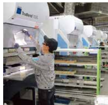
曲げ加工機での作業の様子
